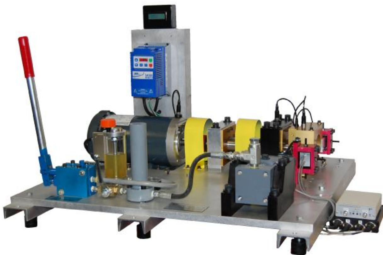
新型轴承故障预测研究实验台
